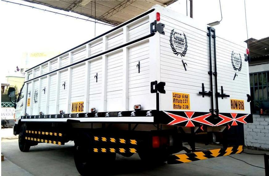
3. Camión de carrocería de madera que se fabrican hasta la actualidad, debidamente señalado. Fuente, intertet. Carrocerías Inforas.
